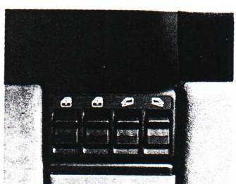
Il comando degli alzacristalli elettrici e dei vetri posteriori a compasso è situato nel centro della plancia, in una posizione scomoda. Per azionarli ci si deve piegare in avanti, staccando sensibilmente la schiena dal sedile.
